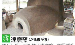
15 達磨窯(だるまがま) 焼(いぶ)し瓦を焼く達磨窯。富岡製糸場の瓦は、この伝統的な窯で焼いており、焼き物としての味や風合いが感じられます。(D2/拡大中央左)
